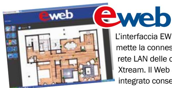
L'interfaccia EWEB permette la connessione in rete LAN delle centrali Xtream. Il Web Server integrato consente di gestire la centrale via Internet, da PC, Tablet, Smartphone, sia in rete locale o da remoto con un web browser.
